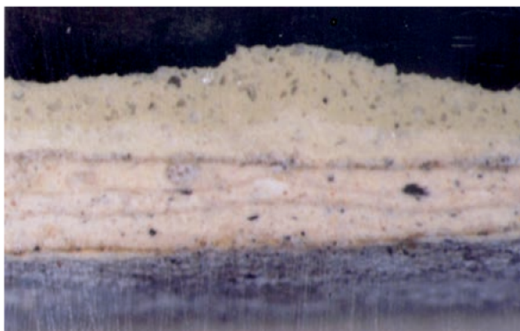
Muestra 3. Estratigrafía de la llaga del almohadillado
