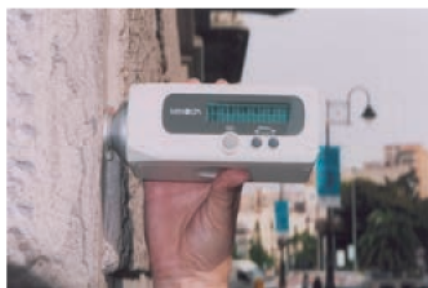
Toma de muestras con colorímetro de contacto. Medidas en parámetros del sistema Munsell
